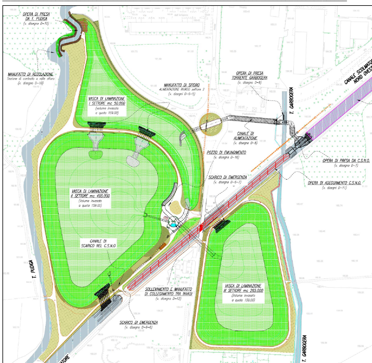
Figura 1 – Planimetria della vasca di laminazione di Senago
