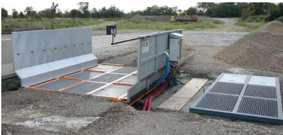
Figura 12 – Esempi di sistema fisso per pulizia idraulica delle ruote dei mezzi d'opera
